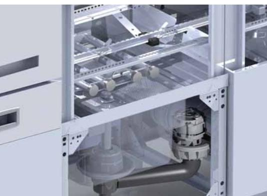
**Das verwendete System erlaubt eine Leistungssteigerung der Pumpe durch direktes Absaugen am tiefsten Punkt des Tanks. Daher arbeitet die Pumpe in ihrem optimalen Leistungsbereich mit maximalem Durchfluss bei reduzierter Nennleistung.**
